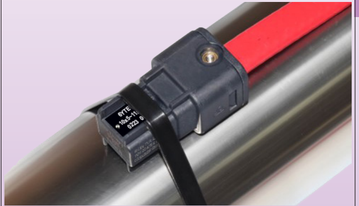
电缆插入拧紧并安装在管道上
