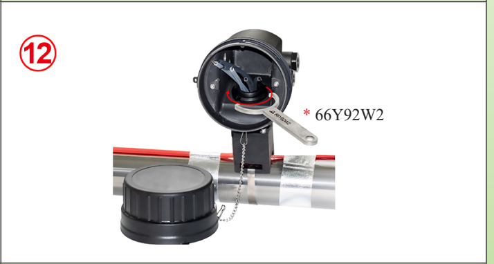
12: 将垫圈放置在脚部上方的凹槽中，然后放在盒子的上面。根据所需的位置调整外壳的方向，然后放置并拧紧带齿的螺母，直到其锁紧为止。
